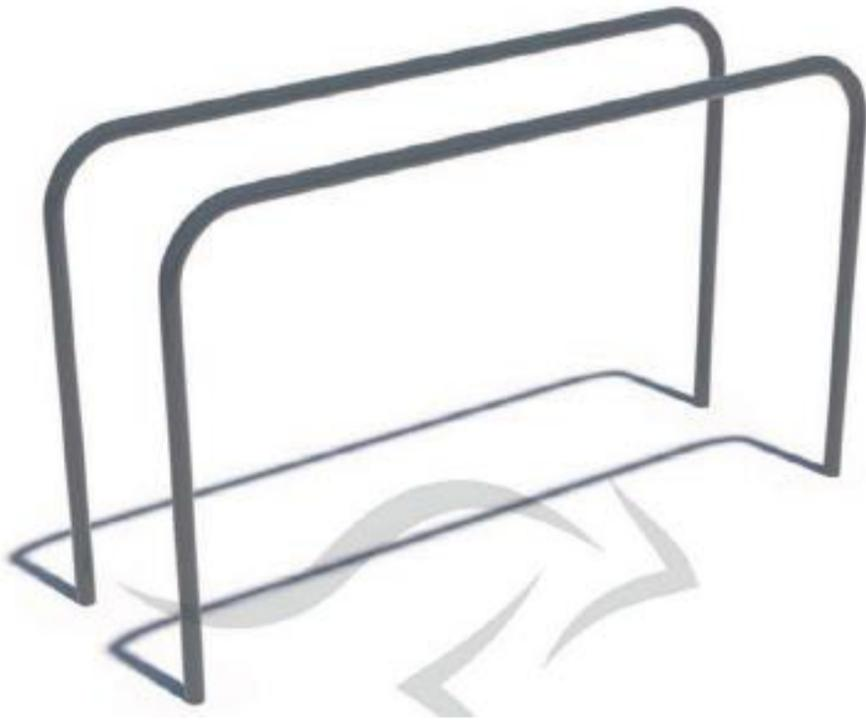
Dos barras paralelas curvadas simétricamente formando un ángulo de 90 grados. Son de hierro galvanizado de 48 mm de diámetro. Tienen 2040 mm de longitud y 1.300 mm de altura.
